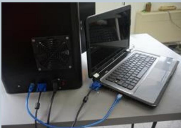
Fig.9 connessione cavo VGA e USB al computer.
