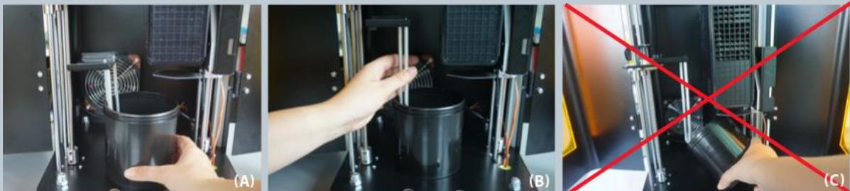
Fig.14 Come posizionare la resina correttamente.
