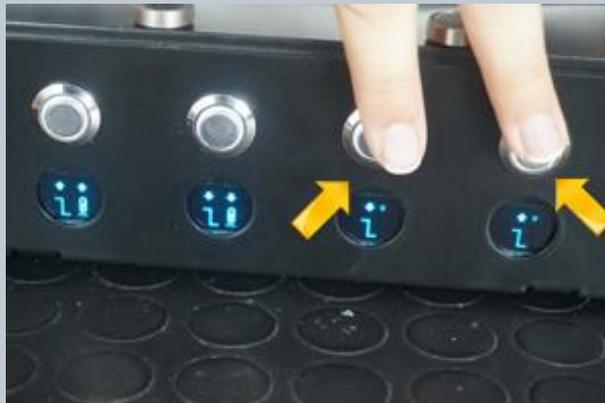
Fig.5 Apertura e chiusura manuale dell'otturatore
