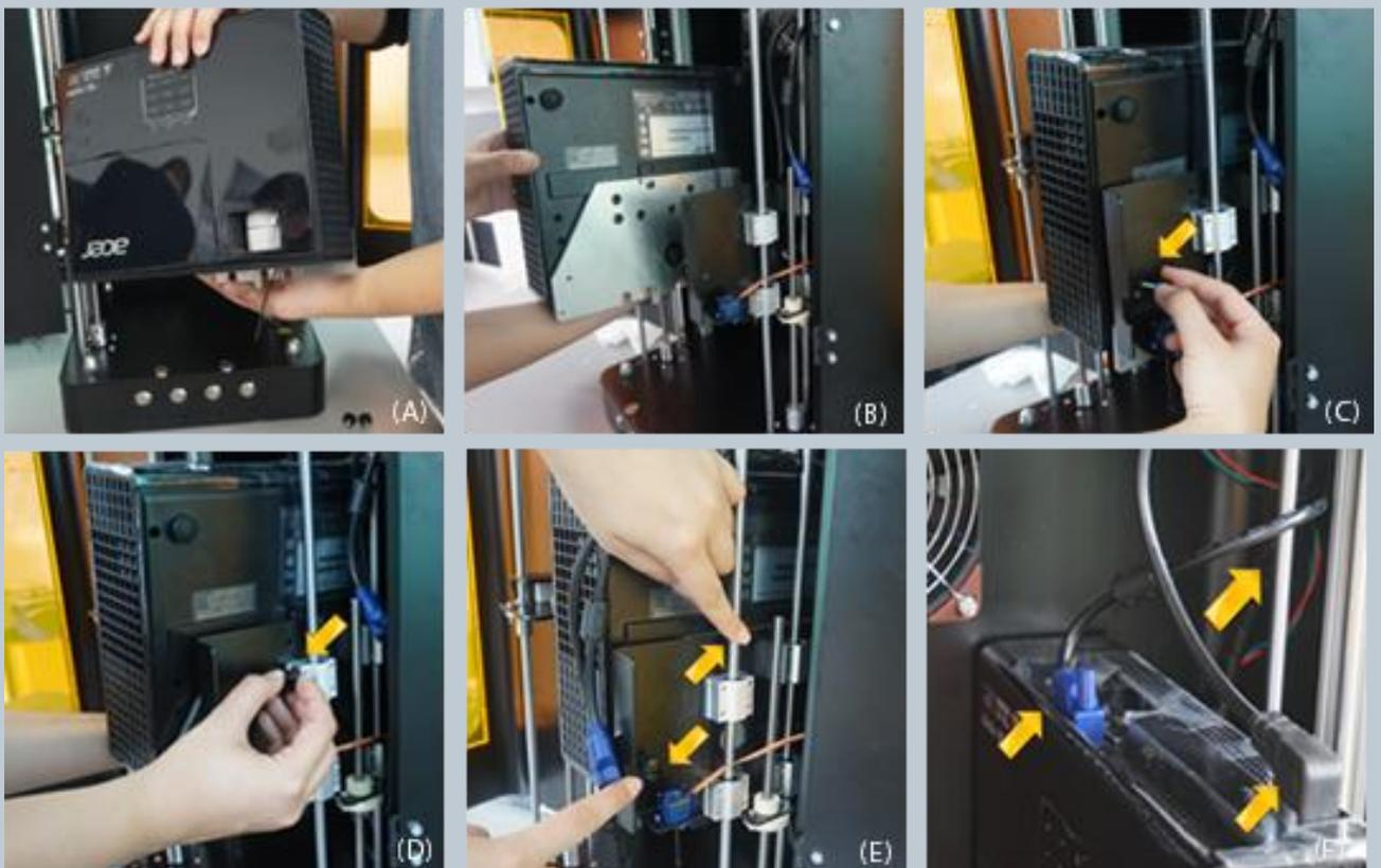
**Fig.3** Installare il proiettore all'interno della stampante
