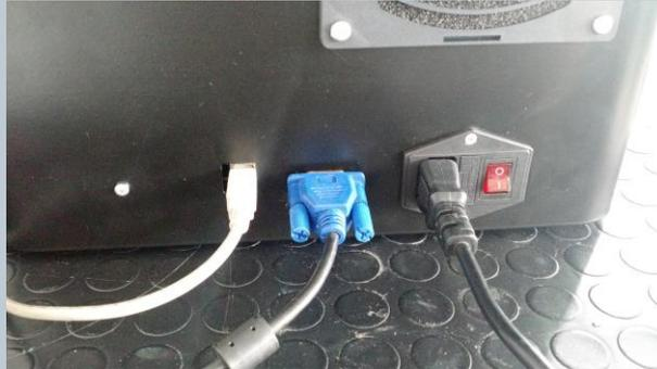
**Fig.10 Collegamento cavo d'accensione**
