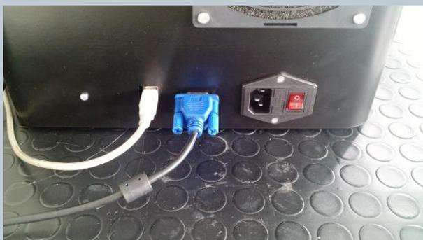
Fig.8 connessione cavo USB e VGA
